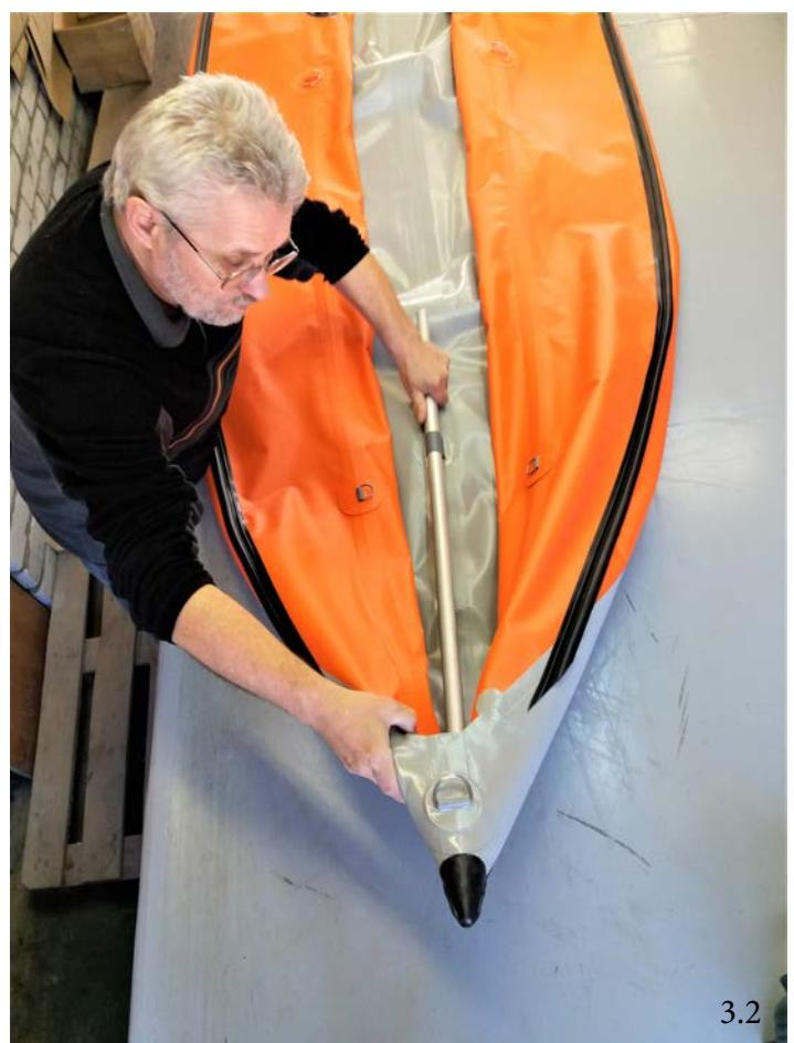
4. Взять средние трубы кильсона и соединить со штевнями. Расположение корма – нос не имеет значения. Фиксатор на одной из частей расположить сверху. На другой части должен быть надета соединительная труба.
